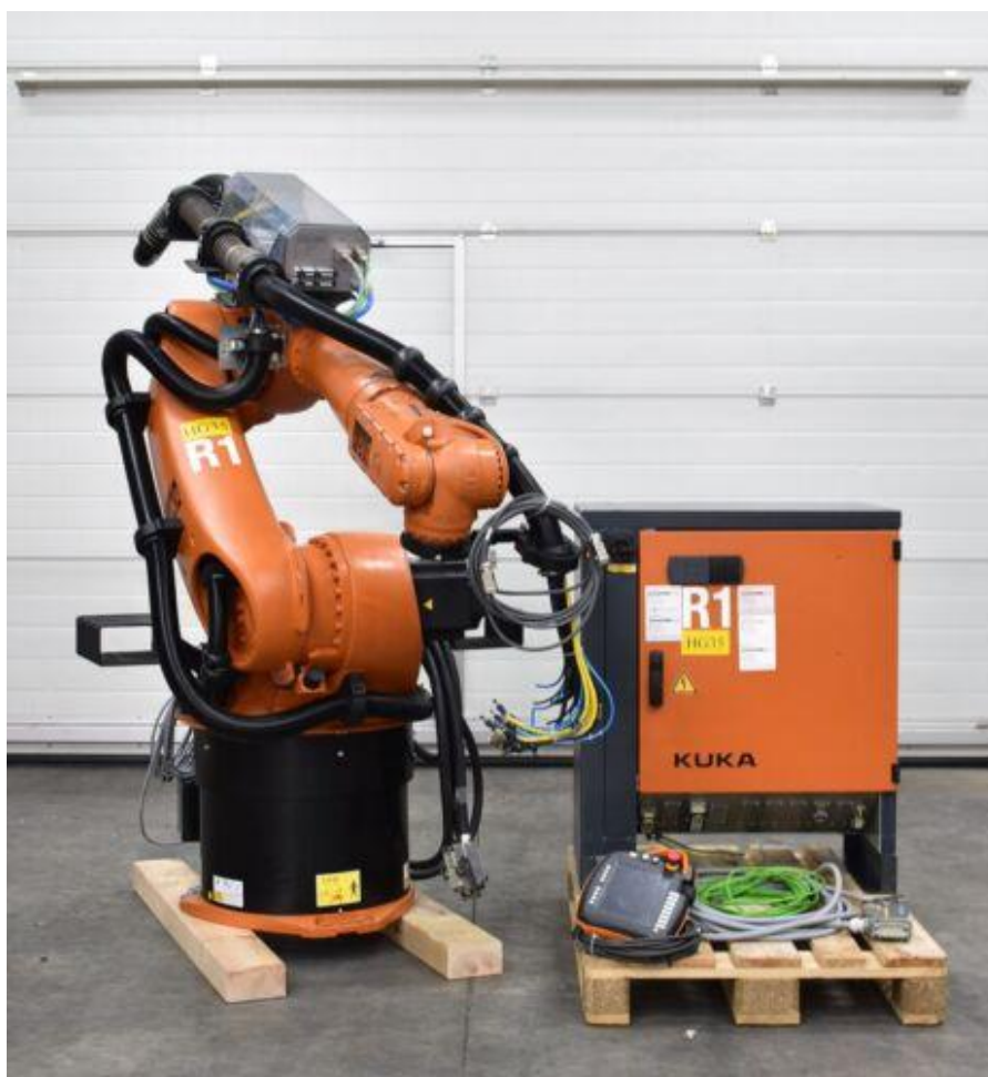
Figura 1. Braço mecânico, painel de comando, unidade de controle e programação Kuka KR 60 L30-3 KRC4
